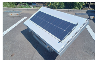
フレキシブル太陽電池を接着した膜構造屋根のモックアップ
