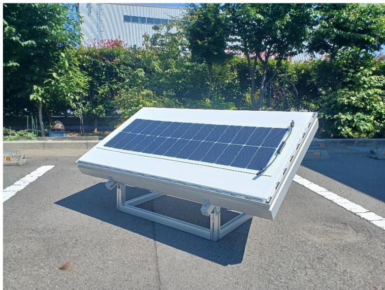
フレキシブル太陽電池を接着した膜構造屋根のモックアップ
