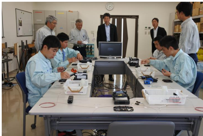
光ファイバケーブルの融着接続実習
