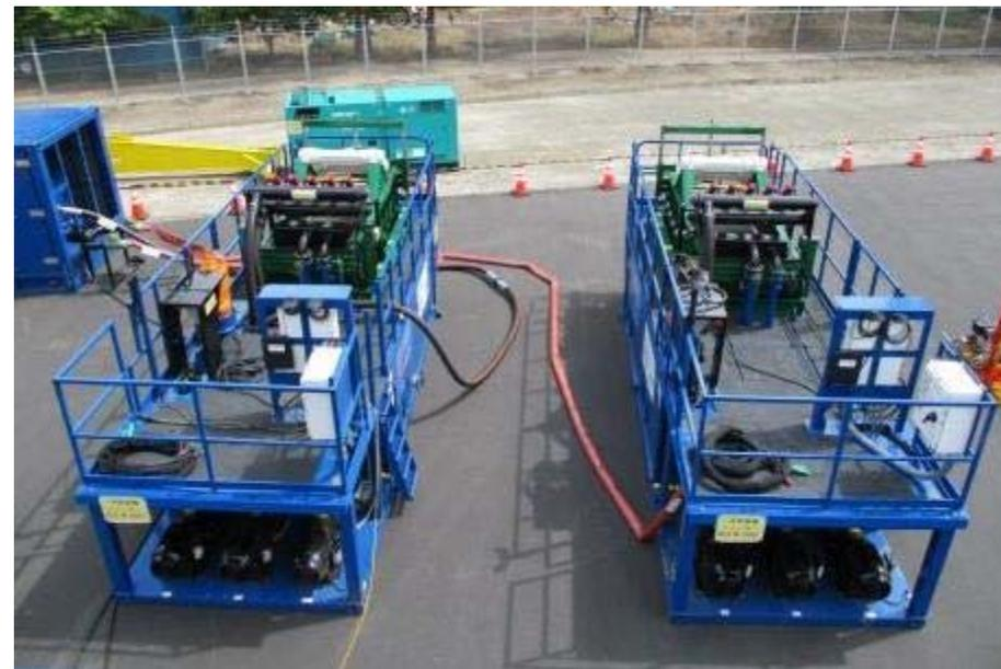
アースシャトル工法機器（マッドポンプ：送泥ポンプ） ※最大吐出量：2.1m<sup>3</sup>/分 総重量：13.5 t ベンツのエンジン
