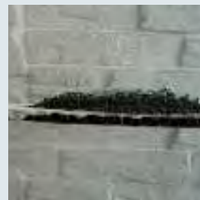
最終的に約 40 倍に膨張し、断熱性に優れた炭化層を形成する
