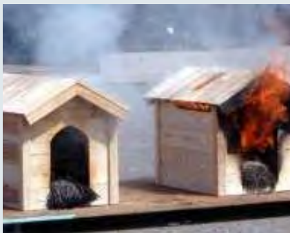
右側の小屋は全焼状態。左側の小屋は一部炭化しているが発火はしていない
