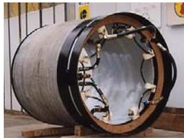
TRS装置(テールボイド拡幅再構築装置)
