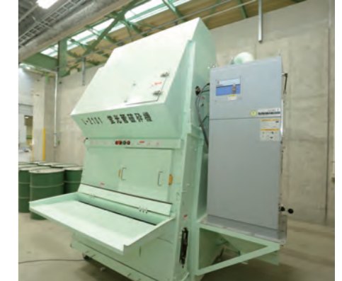
■ 蛍光管破砕機 蛍光管を自動で破砕し、ドラム缶に貯留します。
