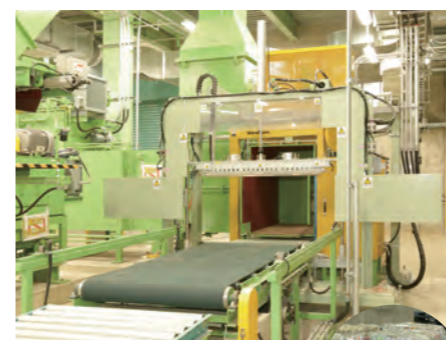
■ プラ容器圧縮梱包機 回収されたプラ容器を圧縮梱包します。
