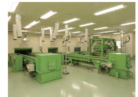
■ プラ容器・ペットボトル手選別コンベヤ 人の手によって、不適物を取りのぞきます。
