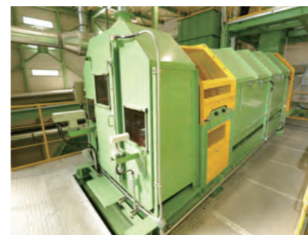
■ 破砕系粒度選別機 回転するドラム内で不燃物とアルミ混じりの可燃物に選別します。
