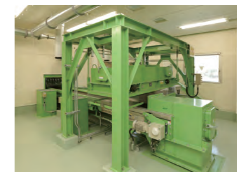
■ 缶類用磁選機 磁力によりスチール缶と、アルミ缶に分けます。
