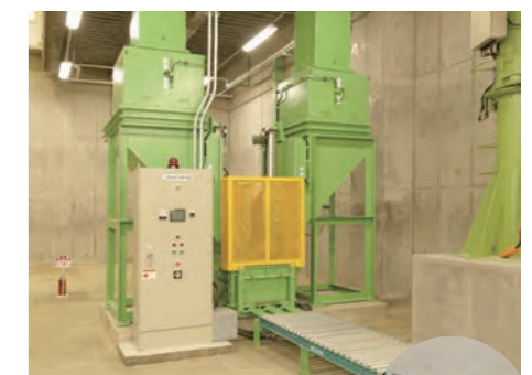
■ 缶類圧縮成型機 回収されたスチール缶とアルミ缶をそれぞれ圧縮成形します。
