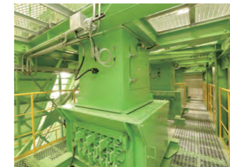
■ プラ容器・ペットボトル破袋機 収集袋を破り、プラ容器・ペットボトル手選別コンベヤへ送ります。
