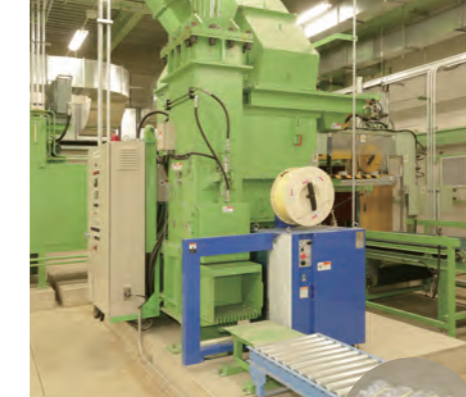
■ ペットボトル圧縮梱包機 回収されたペットボトルを圧縮梱包します。
